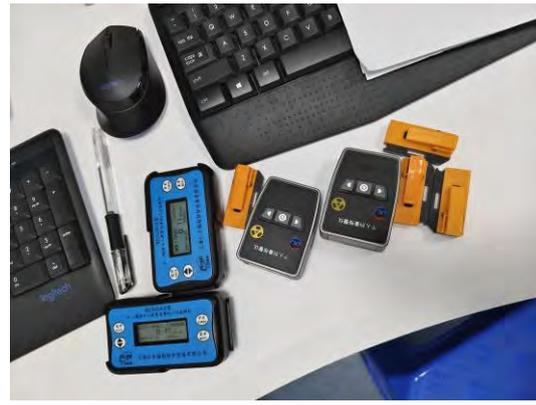
图 3-3.4 个人剂量计、个人剂量报警仪
