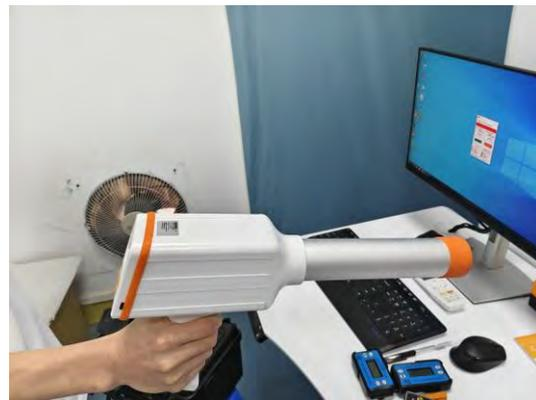
图 3-3.6 便携式 X-γ 剂量率仪
