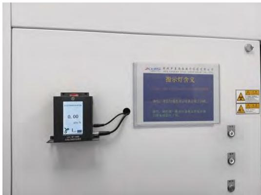
图 3-3.5 在线式辐射监测仪
