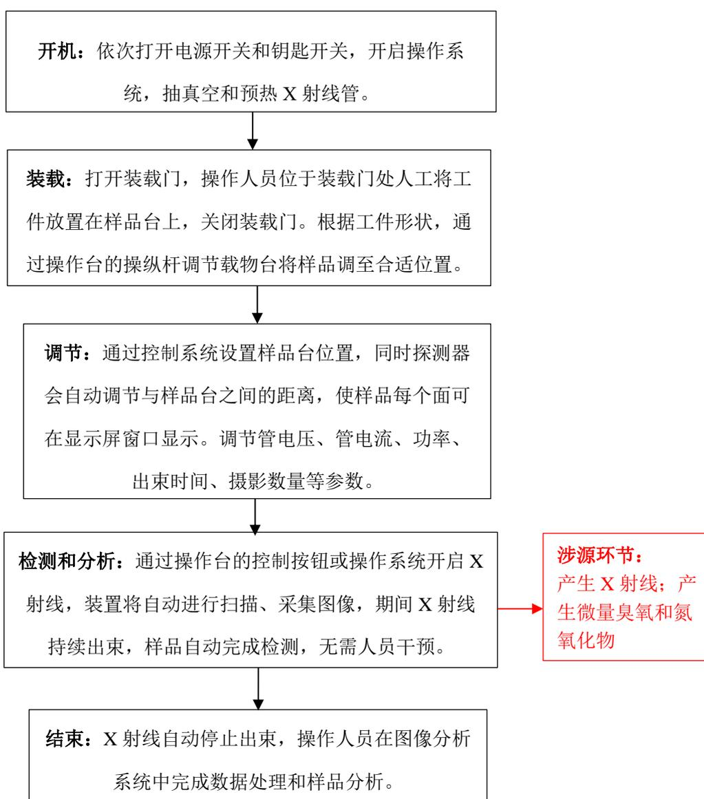
图 2-7 操作流程和产污环节图
