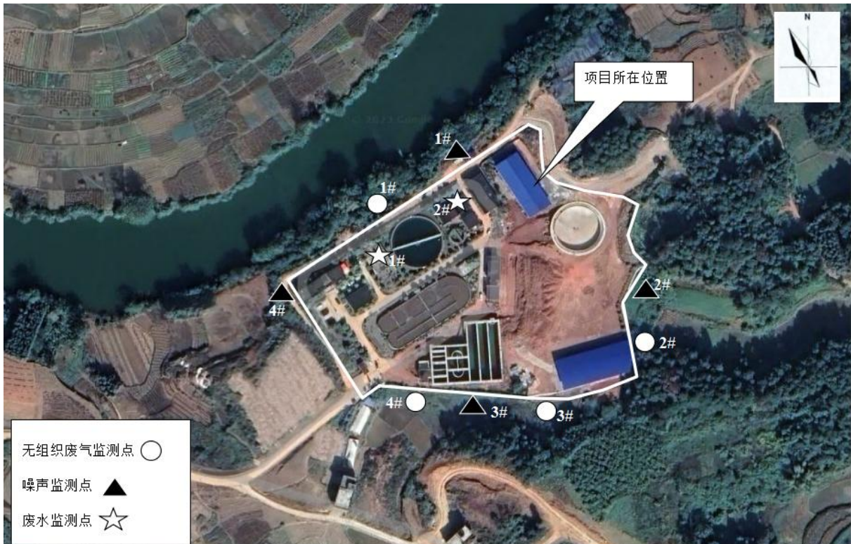
图 6-2 无组织废气、噪声、废水监测点位图
