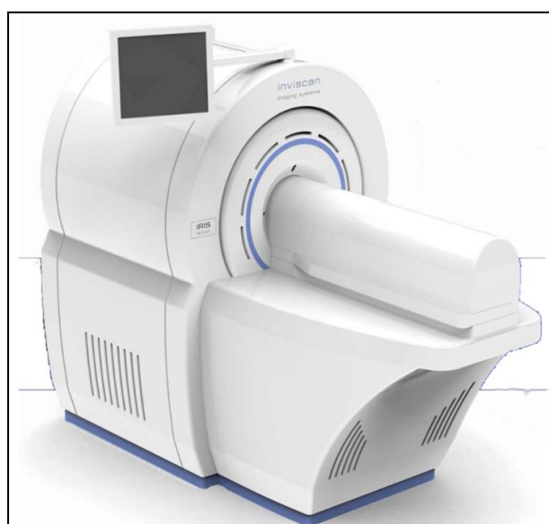
图 9-8 小动物 IRIS 型 PET/CT 设备外观图
