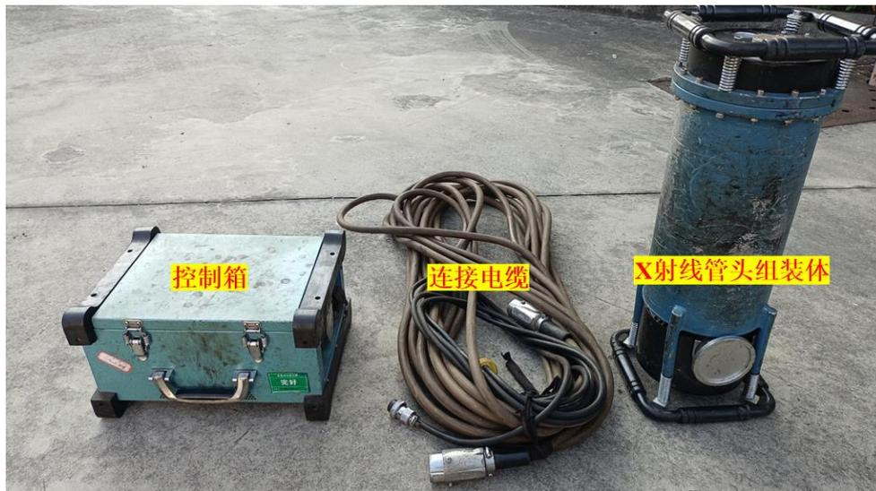
图 9-1 本项目 X 射线探伤机外观图
