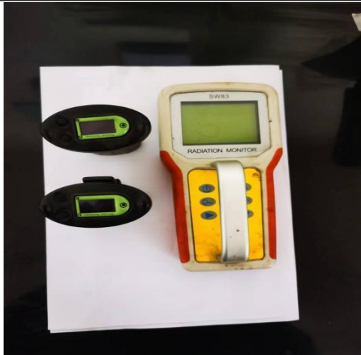
图 3-7 个人剂量报警仪和便携式巡测仪
