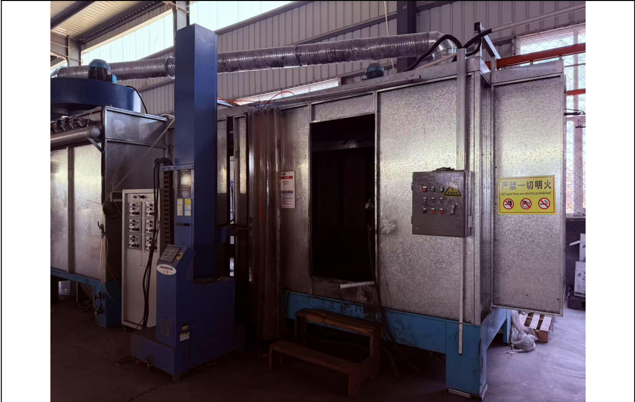
图5 车间喷粉工序
